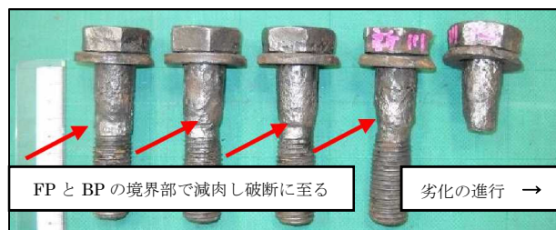
図-5 ボルトが破断に至る過程
