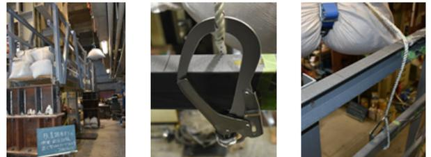
図-5 手すりの衝撃載荷試験のセットアップ状況
