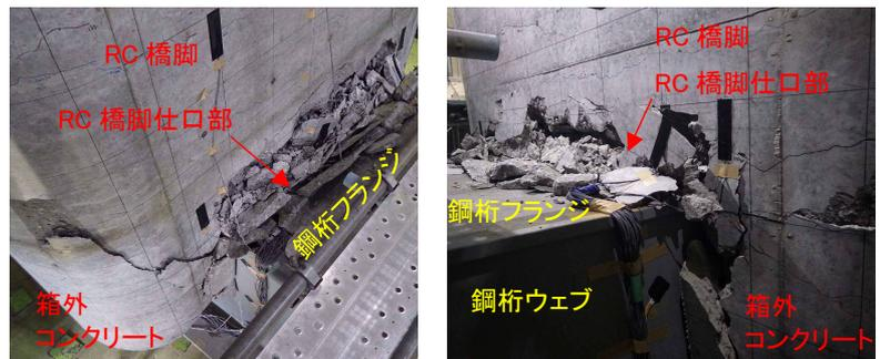
写真-1 試験体 RC 橋脚仕口部の破壊状況
