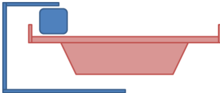
図-1 逆台形の鋼箱桁橋と1台の点検車
