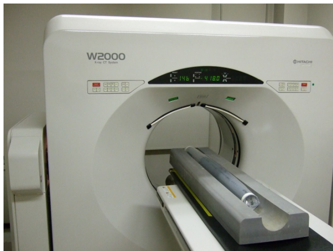
図1 医療用CTシステムのガントリーユニットの患者ベッドに置かれたボーリングコア試料（長さ1m）[1]。塩ビ管でカバーされたコアが、ウレタンフォームに収納されている。
