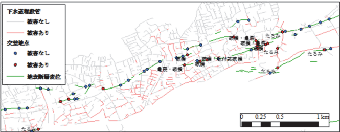
図5 益城町における下水道埋設管路の被害形態
