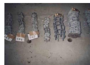
写真-7 中央配筋、せん断破壊した試験体、せん断補強筋
