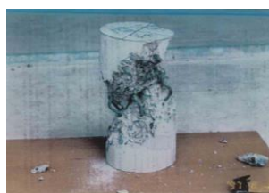
写真-7 中央配筋、せん断破壊した試験体、せん断補強筋
