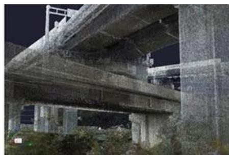
図2. 点群データ(地上レーザ測量)
