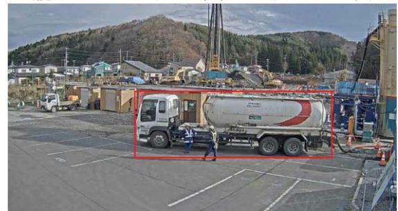
写真6 運搬車両の稼働解析 (車両の認識により運搬間隔や回数を把握)
