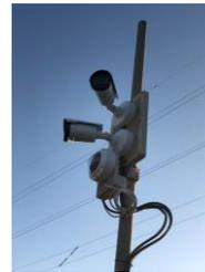
写真1 ネットワークカメラ設置状況
