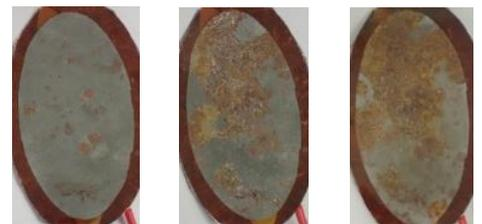
図-6 センサの腐食状況 (左から3, 8, 10サイクル)
