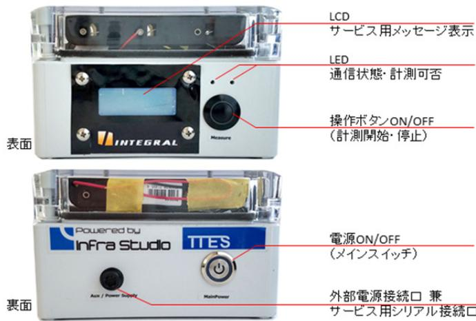
図3 IoT 端末の外形
