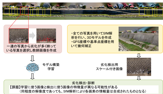
図1 河川護岸の劣化診断支援手法
