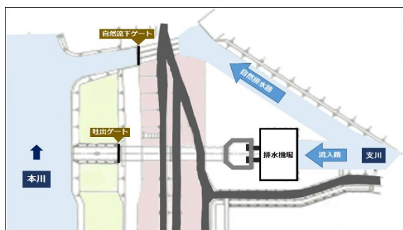
図-1 排水機場ポンプ設備施設全体図
