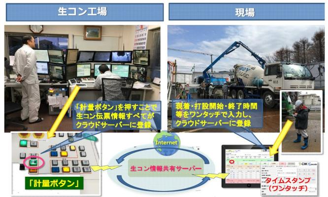
図-1 出荷～運搬～打込み状況のデータ共有の概念
