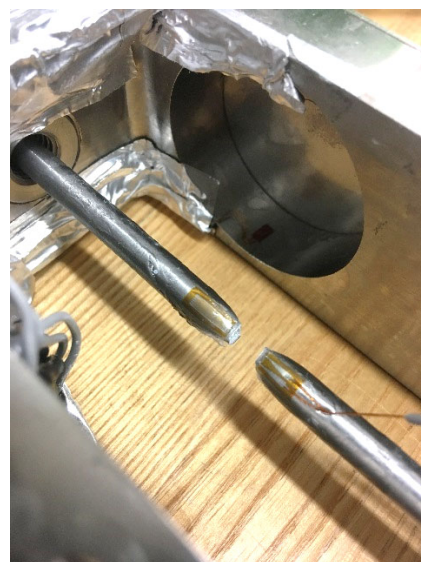
写真-2 試験体の破断状況(6φ)
