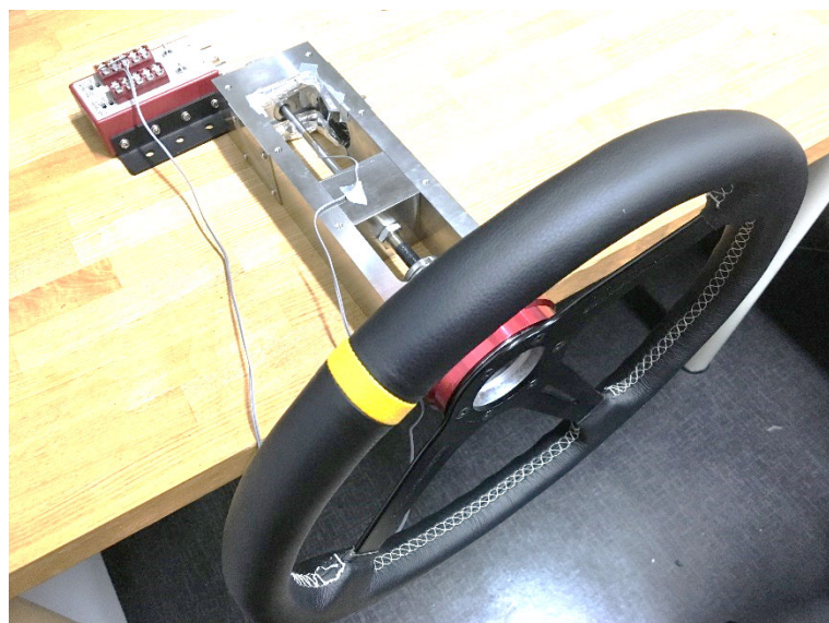
写真-1 ハンドル式卓上小型材料試験機の概観
