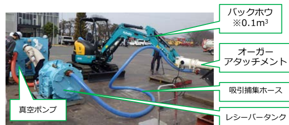
図 5 地上要素試験 機械的除去装置
