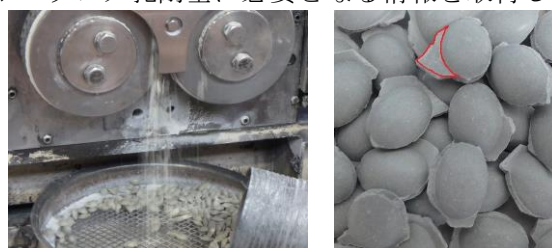
図-1 ペレット製造状況と製造したペレット (右図の赤枠は製造時のバリ)
