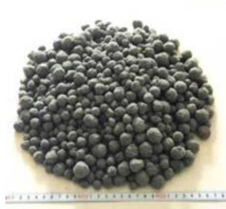
写真-1 覆砂材に活用される Hi ビーズ
