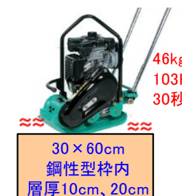
図3 プレートコンパクタ締固め
