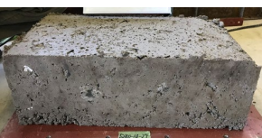
写真6 プレートコンパクタ締固め固化体 (水粉体比27%, 層厚約20cm)
