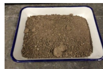
写真1 焼却灰 (10mm 下) 写真2 飛灰 (10mm 下) 写真3 練混ぜ状況 (混合粉体)
