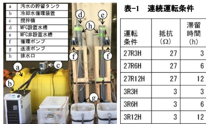
図-3 ケモスタットリアクターへの MFC 設置の様子
