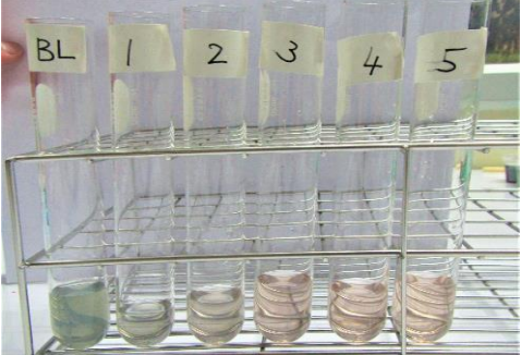
写真 1 硫酸アルミニウムを用いた凝集試験結果
