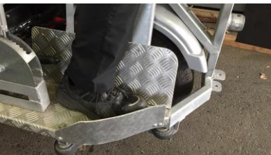
写真 4 運転者ステップ部
