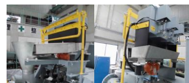
写真-3 SF 自動投入装置
