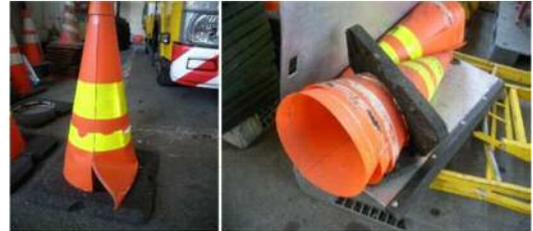
写真2 損傷状況（接着部の剥がれ）
