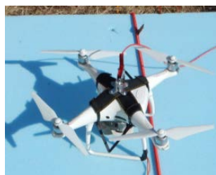
写真2 専用治具取付状況
