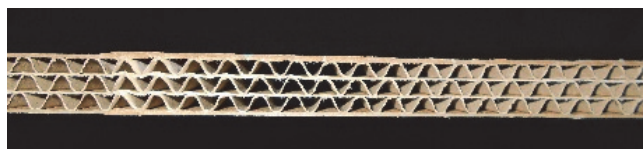
図-1 3層構造の紙素材(厚さ15mm)
