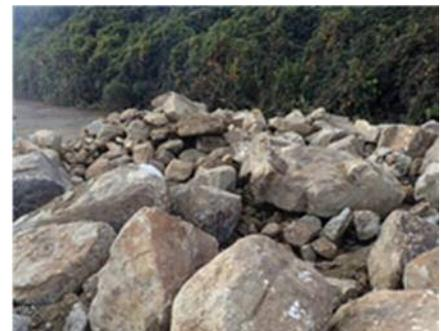
図-1 施工時に発生した転石の例
