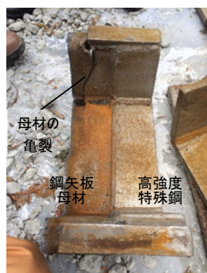
図-7 鋼矢板母材部の亀裂と部分補強
