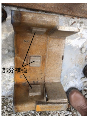
図-7 鋼矢板母材部の亀裂と部分補強
