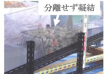
写真-1 流水抵抗性試験状況
