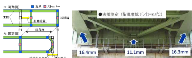
図 7 P2 橋脚部端横桁の変形概要図及び測定結果
