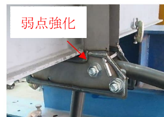
図-6 試験結果（左改良前：1回目 4.0kN 右改良後：2回目 6.8kN）
