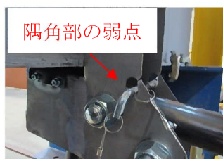
図-6 試験結果（左改良前：1回目 4.0kN 右改良後：2回目 6.8kN）
