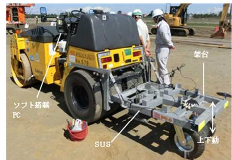
図-1 衝撃加速度法—連続測定システム
