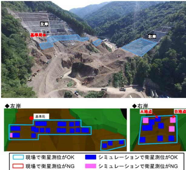
図3 シミュレーションと現地調査結果の比較例
