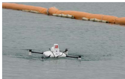
写真－2 SWANS による濁度計測状況
