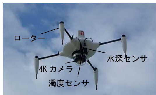
写真-1 水面浮体型ドローン SWANS
