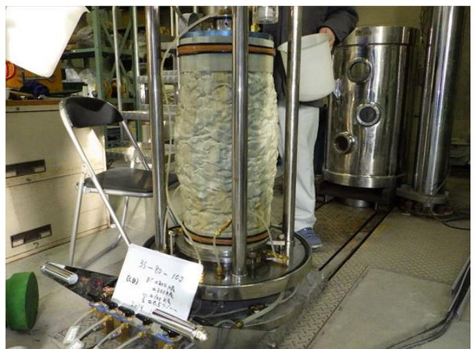
写真-1 大型三軸圧縮試験機 (試験後)
