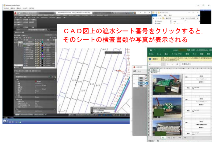
図5 CAD平面図と写真データの連携(例)
