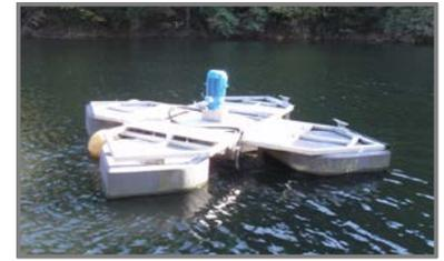
写真-1 プロペラ装置の外観
