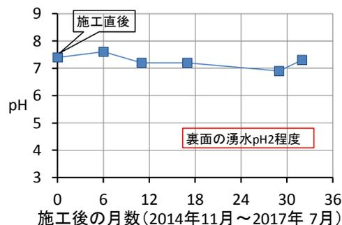
図-3 植生基材のpHの経時変化
