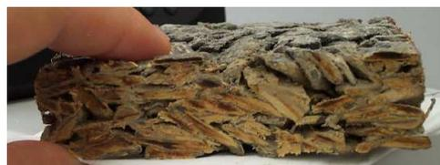
写真-2 チップクリートの断面
