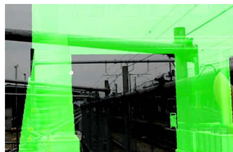
図-7. MRグラスによる工事目的物の現地再現例
