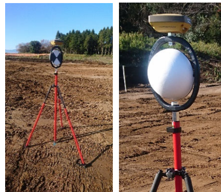
写真-1 多機能ターゲット（遠景）
