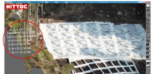
図-3 グラウンドアンカーの諸元を記録した3次元モデル
