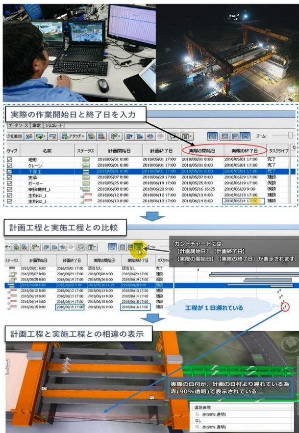
図-4 現場での4DCIMによる工程管理
