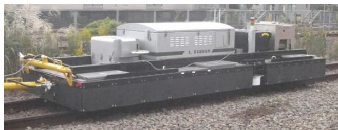
図-1 狭軌用牽引式軌道検測装置
