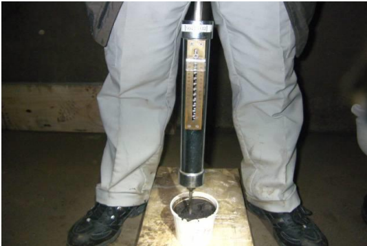
写真-3 プロクターニードル貫入試験
