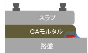
図-1 凍結融解による損傷のイメージ
