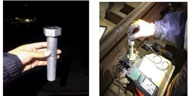
写真1 計測ボルト 写真2 超音波法による測定
