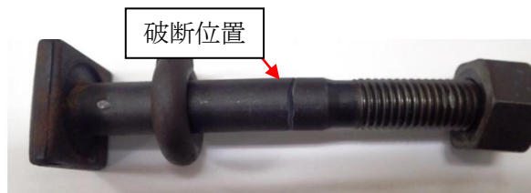
写真 2 ボルト折損状況
