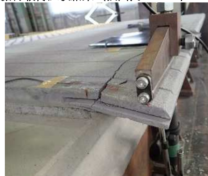
写真-1 開発タイル破壊性状
