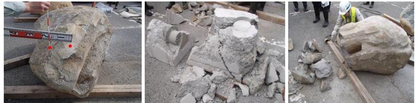
写真-3②玉石破砕前 (赤丸：削孔位置) 写真-4①コンクリートブロック破砕後 写真-5②玉石破砕後
