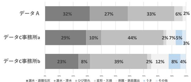
図-3 データ A とデータ C の事務所 a, b の損傷傾向
